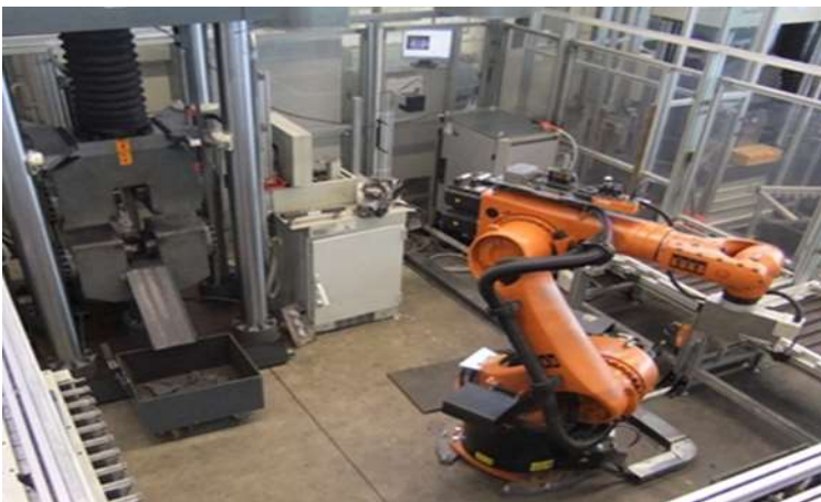
Machine de traction automatisée (1200 kN)
