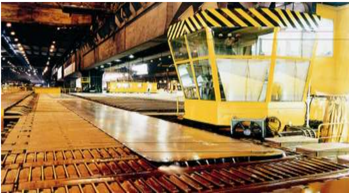
Machine US à sur la ligne de cisailage à Dilling pour les épaisseurs jusqu'à 55 mm
