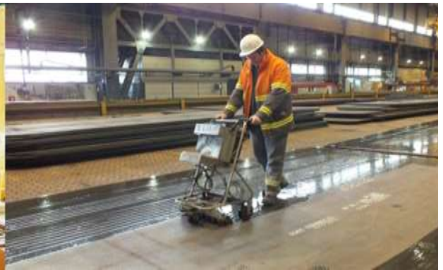
Contrôle US manuel au sol pour les plus fortes épaisseurs jusqu'à 400 mm
