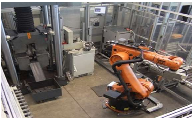
Machine de traction automatisée (1200 kN)
