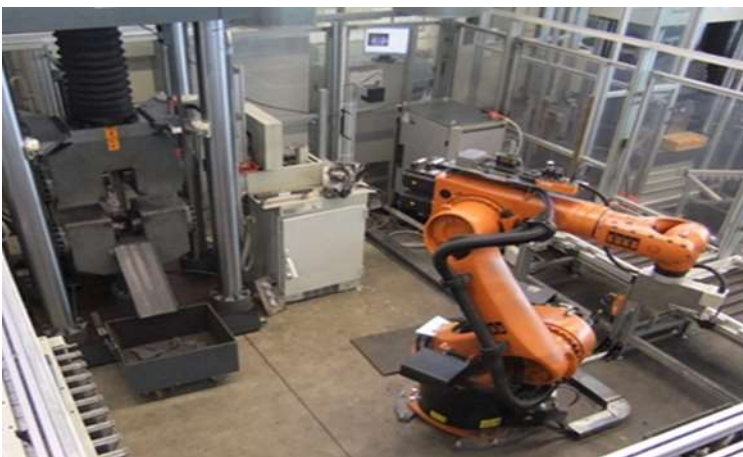
Automatisierte Zugprüfmaschine (1200 kN)
