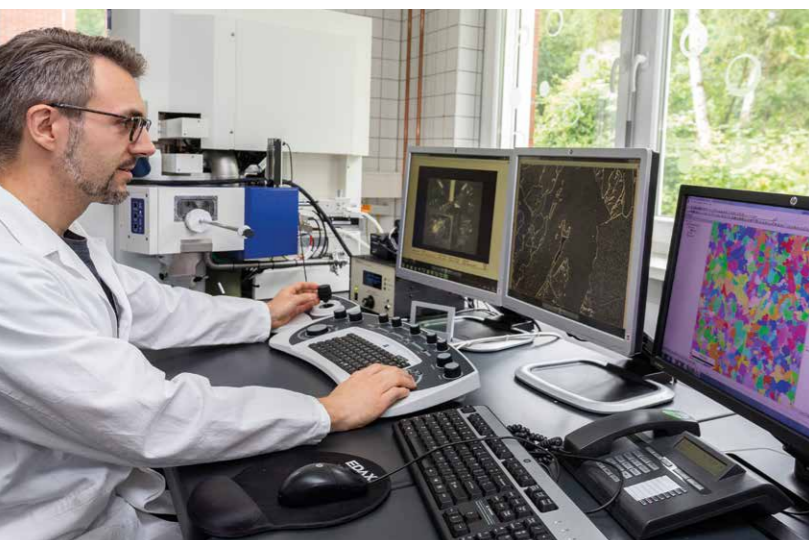
Untersuchung eines CrMo-Stahls am Rasterelektronenmikroskop (REM).
