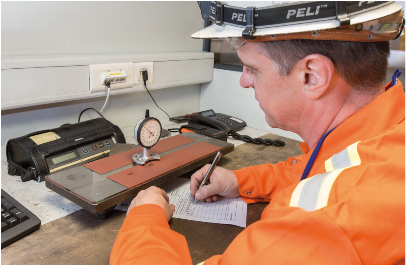
Un collaborateur mesure l'épaisseur de la couche de peinture.
