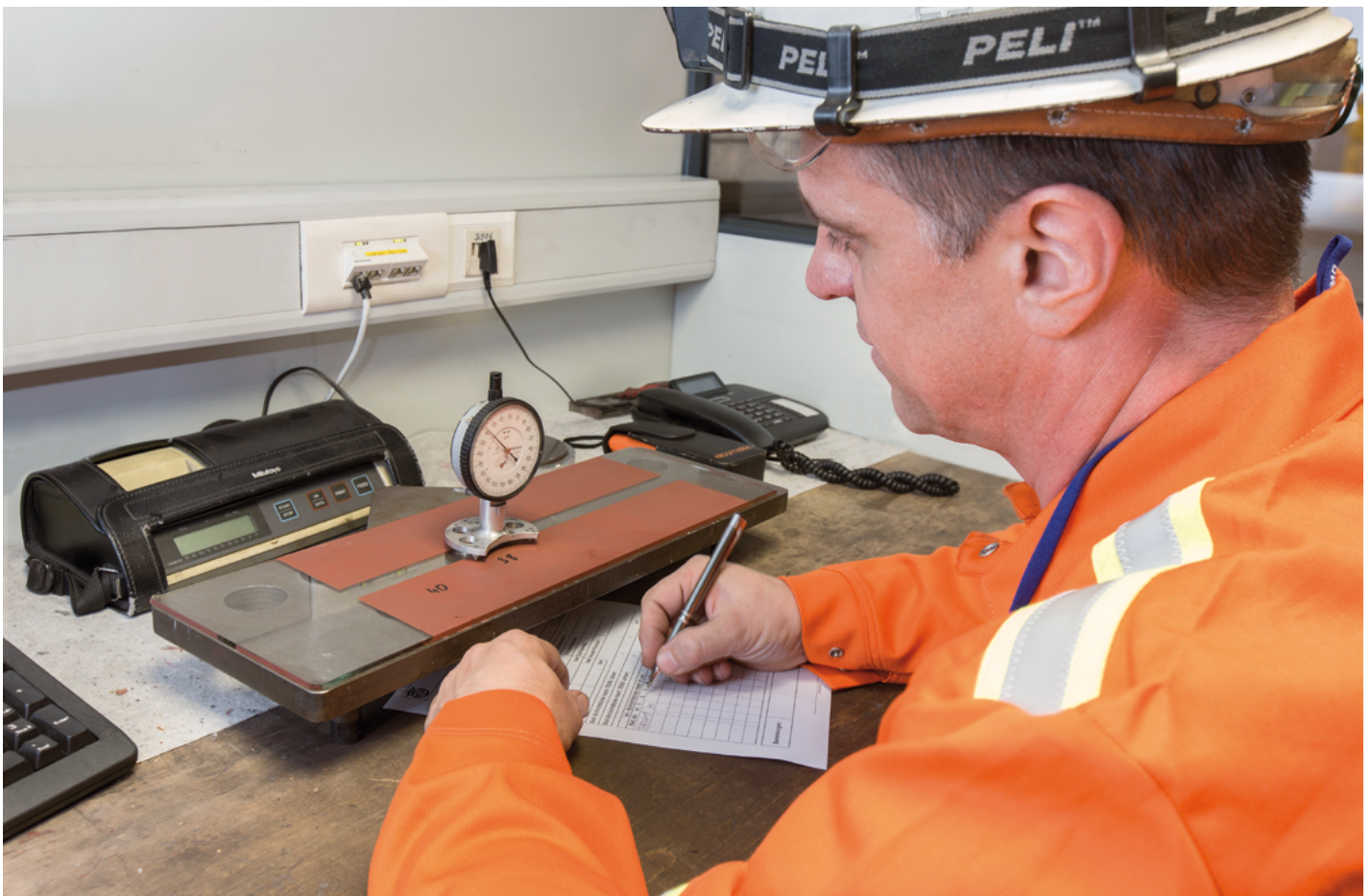
Ein Mitarbeiter misst die Schichtdicke
