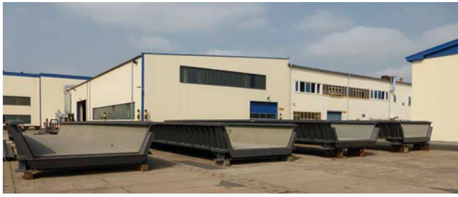
Bild 2 Dickblechtrogrücken bereit für die Installation Trough bridges with thick deck plates ready for installation
