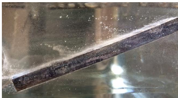
Abbildung 6: Diffusibler Wasserstoff entweicht aus der Testraupe im Glycerin-Bad.
