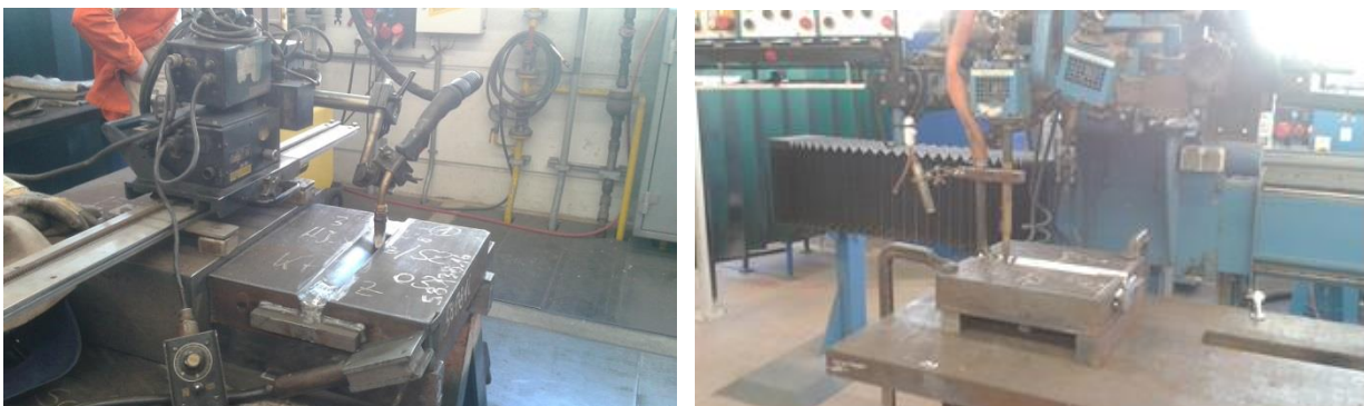
Abbildung 3: MAG bzw. UP-Schweißung der Tekken-Probe
