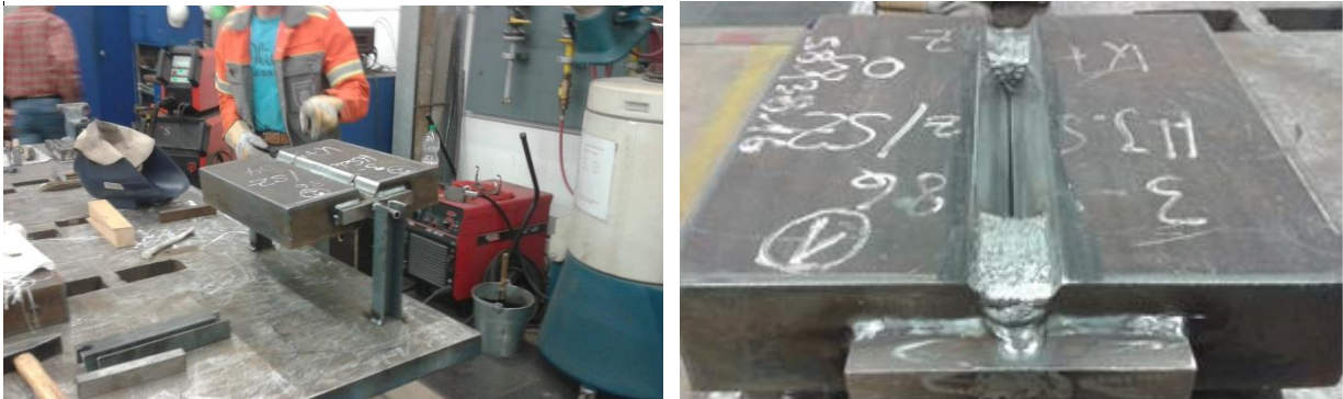
Abbildung 2: Schweißung der Ankerrihte und fertig zusammengebaute Probe
