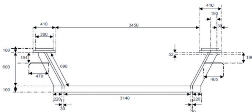
Coupe transversale d'un pont à poutres latérales constitué d'une dalle en acier réalisée à partir d'une tôle de 100 mm d'épaisseur (échelle non respectée).
