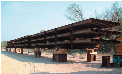
Bild 6 Panelplatten im Werk Lauterbourg vor Versand
