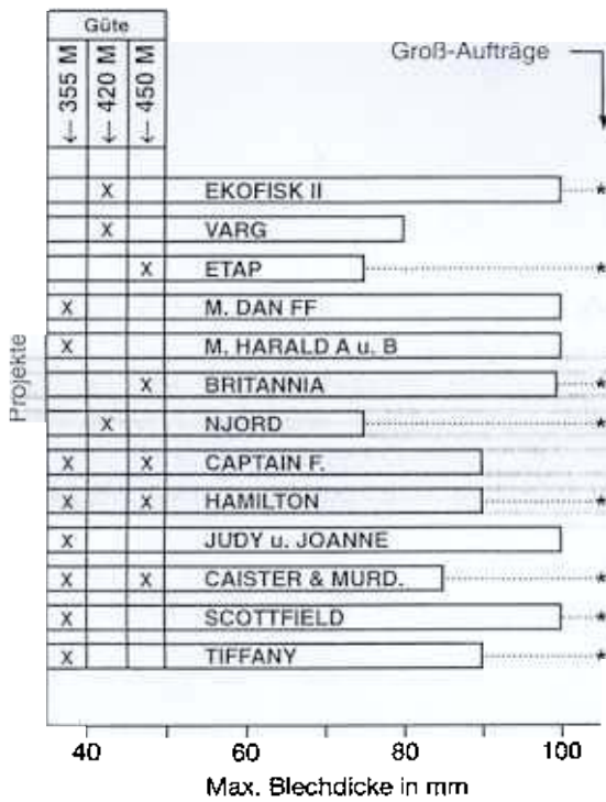
Bild 14. Typische Bereiche von Blechdicke und Streckgrenzenklasse ausgewählter Offshore-Projekte der letzten Jahre (mit TM-Stählen)
