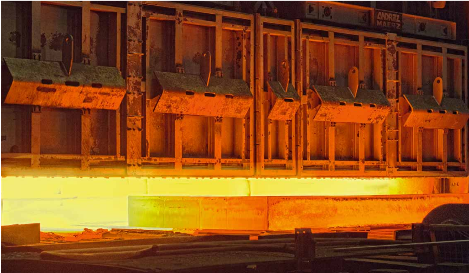
Reduktion von Energieverbrauch und CO 2 -Ausstoß durch ein neues Regelungskonzept am Brammenstoßofen im Walzwerk
