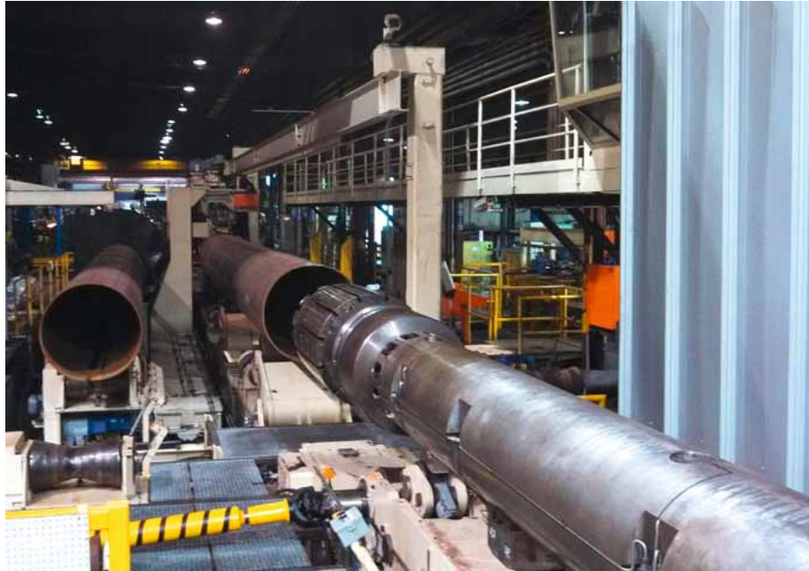
Der neue Expander bei Berg Steel Pipe in Panama City
