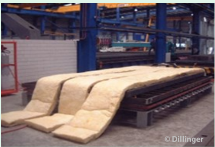
Langsames Abkühlen von DILLIDUR
